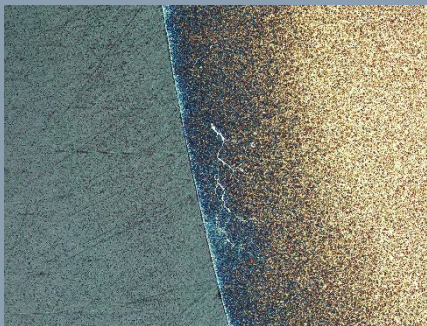
Beispiel eines Lagerschadens, der erkannt werden soll
